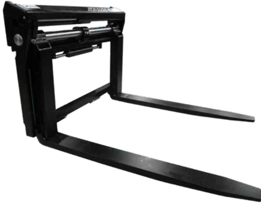
Le positionneur de fourches série MP de Bolzoni Auramo est doté d'une barre ronde chromée avec bagues autolubrifiantes sur laquelle glissent les guides, pour un positionnement à la fois rapide et précis.
