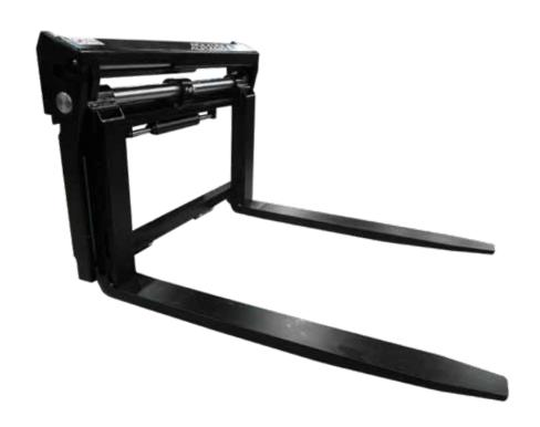
Il posizionatore forche Bolzoni Auramo della serie MP offre un posizionamento veloce ed accurato delle forche , grazie allo scorrimento dei supporti forca su barra cromata, con boccole autolubrificanti.
