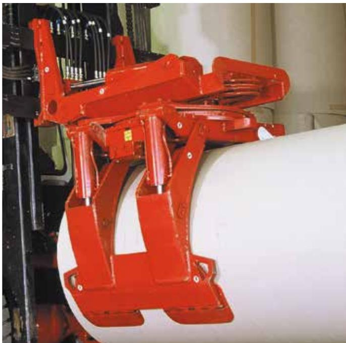
La pinza rotante e ribaltante TAR-RH Bolzoni Auramo è stata progettata per il trasporto sia in verticale che in orizzontale di singole bobine di carta.
