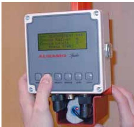
Le positionnement se fait sans précautions particulières, l'alignement entre le spider et la bobine est automatiquement compensé et calculé par le logiciel d'analyses.
