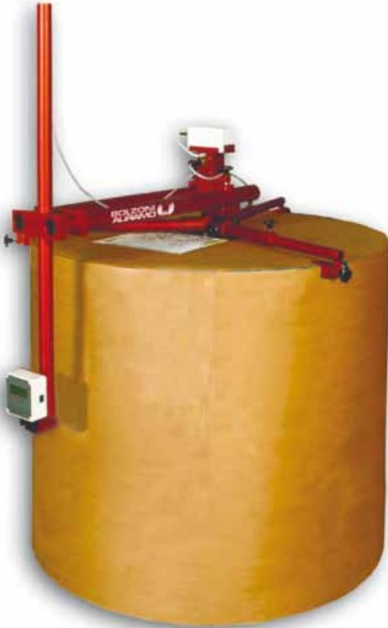
Afin de mieux contrôler la qualité de vos bobines de papier, Bolzoni Auramo a créé le Spider. Fiable, précis et de technologie de pointe, le spider mesure les variations du rayon des bobines de papier à l'aide de technologie informatique et ultrasons les plus avancées et ce sans endommager les bobines ni abîmer leur emballage.
