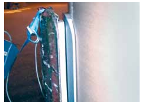
Il pattino di prova misura la forza di serraggio tra la bobina di carta ed il pattino di presa.
