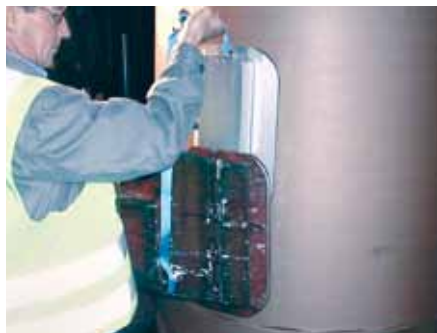
Grazie alla sua forma sottile, il pattino di prova si adatta a tutti i diametri di bobine.
