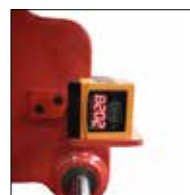
3 Sensores de profundidad de la carga Detecta el tipo y la configuración de la carga, la altura, la profundidad y la distancia del equipo
