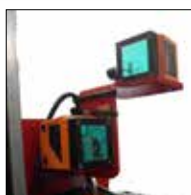
1 Capteur laser supérieur Détection de la présence de cartons dans la zone supérieure des patins.
