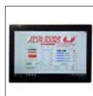
4 Tablette de configuration Contrôle des paramètres de pression en fonction des plages d'ouverture.
