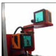
1 Sensore laser Rileva nella parte superiore del pattino il tipo e la presenza in altezza del carico.
