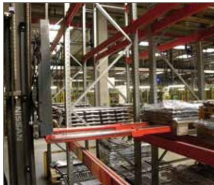
**Apilamiento en doble profundidad:** aumenta el volumen de almacenamiento y un ahorro notable de espacio, en particular acoplando las horquillas extensibles a una carretilla retráctil diseñada para operar en pasillos estrechos.
