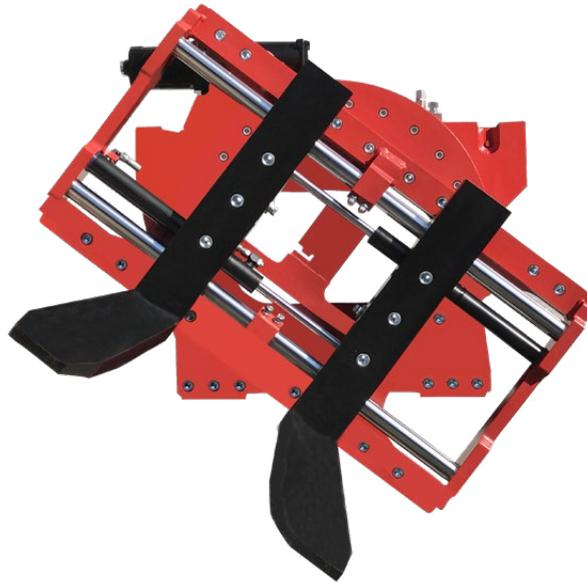
Das MEYER drehbare Zinkenverstellgerät mit Präzisionsachsenführung kann den Gabelabstand innerhalb der Gerätebreite verstellen. Der 360° endlose Drehbereich erlaubt zusätzlich ein flexibles Drehen und Entleeren. Dabei sorgt das Achsführungskonzept mit Hochleistungsbuchsen für effiziente Arbeitszyklen, optimalen Gleichlauf und sauberes Arbeiten. Die robuste Konstruktion verfügt über eine optimale Durchsicht und ermöglicht höchste Resttragfähigkeiten.
