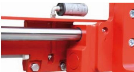
La lubrificazione automatica garantisce intervalli di manutenzione identici per il carrello elevatore e l'attrezzatura, evitando interventi supplementari
