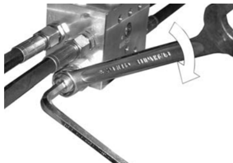
Serrage à fond du contre-écrou
