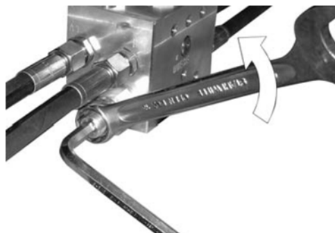
Dévissage du contre-écrou
