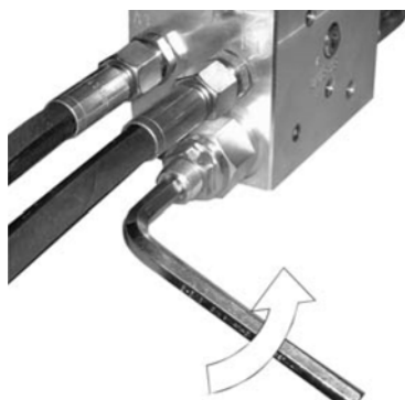
Rotation arrière de la vis de réglage
