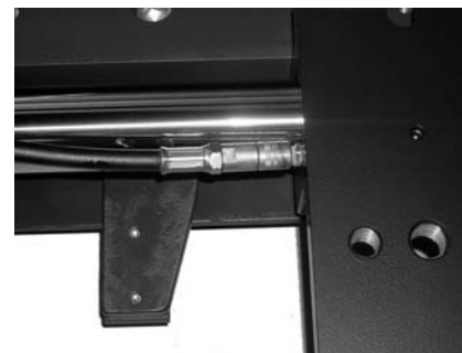
Engrase de los puntos de apoyo en los portabrazos
