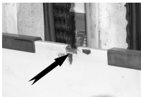
Ranura central de la placa portahorquillas de la carretilla elevadora
