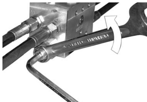
Procedimiento de aflojar la contratuerca.
